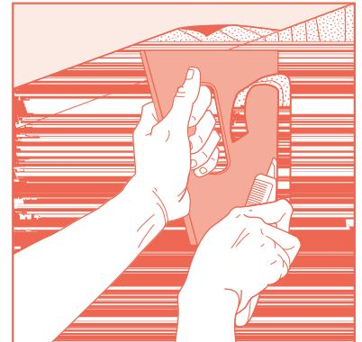
**4.** Afficher le second lé par recouvrement et couper les deux épaisseurs en même temps.
