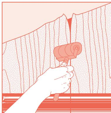
**5.** Fermer le joint en maroufflant avec une roulette et essuyer avec un chiffon humide.
